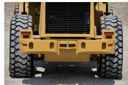
**Contrapeso.** El contrapeso de dos piezas está integrado en el diseño del 938H y proporciona protección adicional para las luces al incorporarlas en la parte superior de la estructura.
