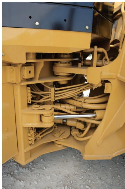
**Enganche.** La distancia entre las planchas de enganche superior e inferior contribuye de forma importante al rendimiento de la máquina y a la vida útil de los componentes. El diseño de enganche Caterpillar proporciona excelente distribución de carga y vida útil de los cojinetes. Tanto los pasadores de enganche superior como inferior pivotan en cojinetes de rodillos cónicos
