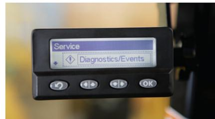
**Messenger.** El sistema Messenger ofrece la comodidad de proporcionar retroalimentación visual y en tiempo real sobre las condiciones de operación del motor y de la máquina. Este sistema proporciona información y códigos de diagnóstico, mantenimiento y parámetros del sistema.
