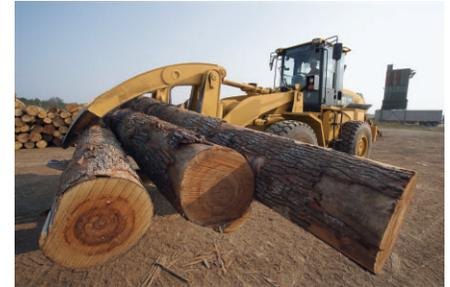
**Horquillas.** Se dispone de horquillas para tarimas, para troncos y aserraderos en aplicaciones forestales y para manipulación de materiales.
