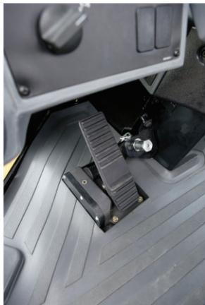
**Sistema Integral de Frenado.** El Sistema Integral de Frenado, exclusivo de Cat, reduce las temperaturas del aceite de los ejes y aumenta la suavidad del neutralizador de la transmisión. El IBS tiene un impacto directo en la durabilidad de los ejes y frenos, especialmente en aplicaciones en las que se tienen que recorrer largas distancias y aplicar constantemente el freno.
