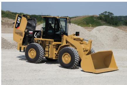
Dispone de un solo cilindro de levantamiento mecánico con retroceso manual que abre el capó. El capó inclinable permite un excelente acceso a los compartimientos de enfriamiento y del motor y, si es necesario, todo el capó puede quitarse usando los puntos de levantamiento integrados.
