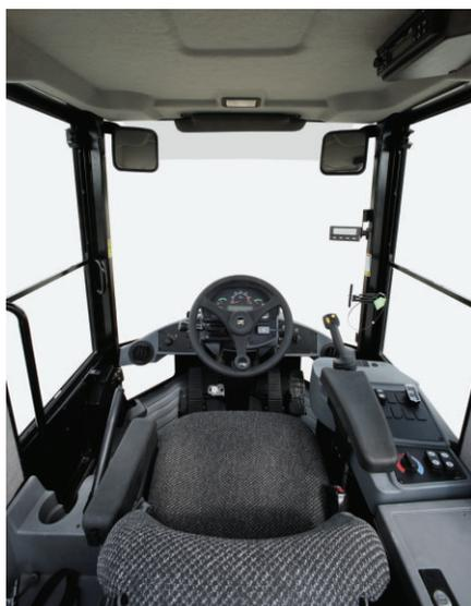
**Asiento.** El asiento durable se ajusta en seis posiciones para acomodarse a todas las tallas de operadores. El asiento se caracteriza por tener un soporte de la zona lumbar, tipo automóvil, para proporcionar máxima comodidad. El asiento Comfort C-500 Cat con suspensión neumática es optativo, con espaldar y cojín con calefacción.
