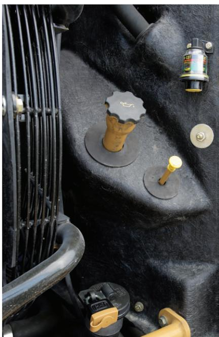
Con el capó cerrado pueden realizarse comprobaciones rápidas del nivel de aceite del motor, de la mirilla de refrigerante y del indicador de admisión de aire, a través de la puerta de servicio lateral.
