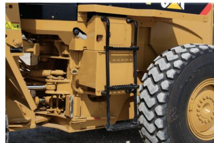
**ENTRADA Y SALIDA.** La escalerilla con un patrón de escalón agresivo mantiene al mínimo la acumulación de escombros. La escalerilla está inclinada 5° hacia adelante para facilitar la entrada y la salida.
